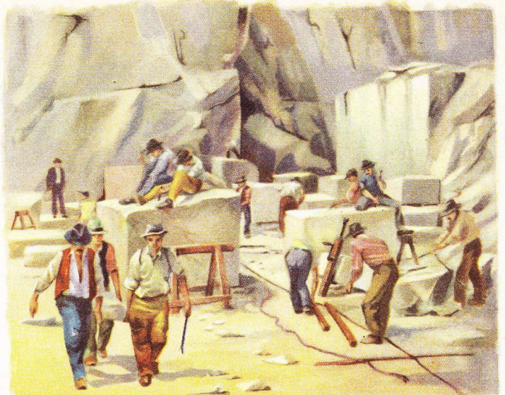
Blocs équarris avec un maillet ou avec une machine spéciale.
