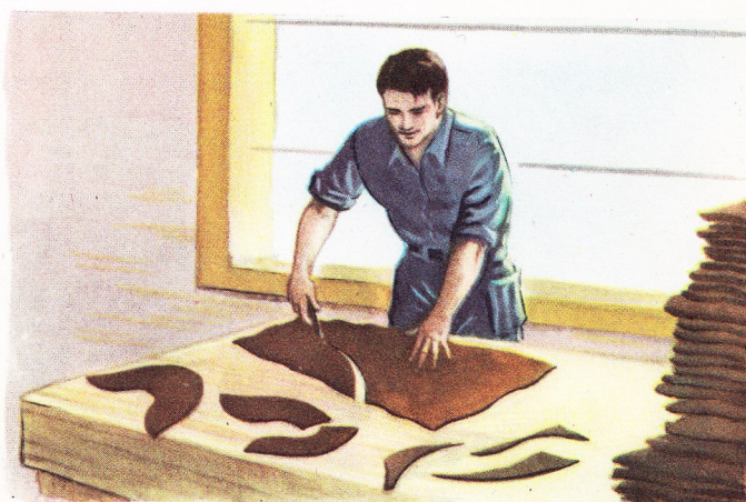
Le coupeur se sert d'une lame très effilée pour tailler les différentes parties de la chaussure. Pour les chaussures moins chères, le découpage s'opère mécaniquement, d'après un même modèle.
