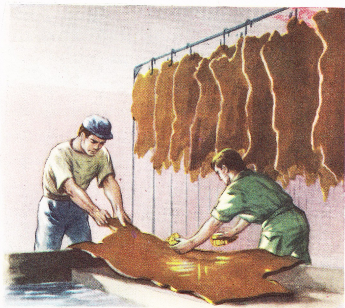
Le tannage des peaux est d'une grande importance pour la confection des chaussures. Le tannage à base de produits minéraux (Chrome) a succédé au tannage à base de produits végétaux (écorce de chêne). Il rend le cuir plus résistant et plus souple et a permis l'utilisation de peaux plus fines.
